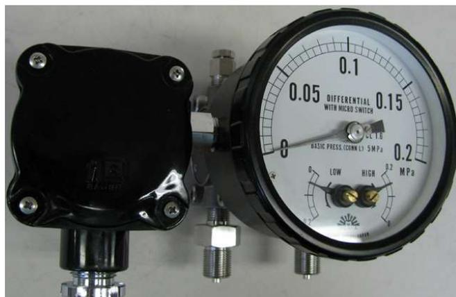
※基準圧力の定義は、2ヶ所の圧力の基準になる方の圧力又は変動しない(変動の少ない)方の圧力、片耐圧の定義は、最大過差圧としております。
